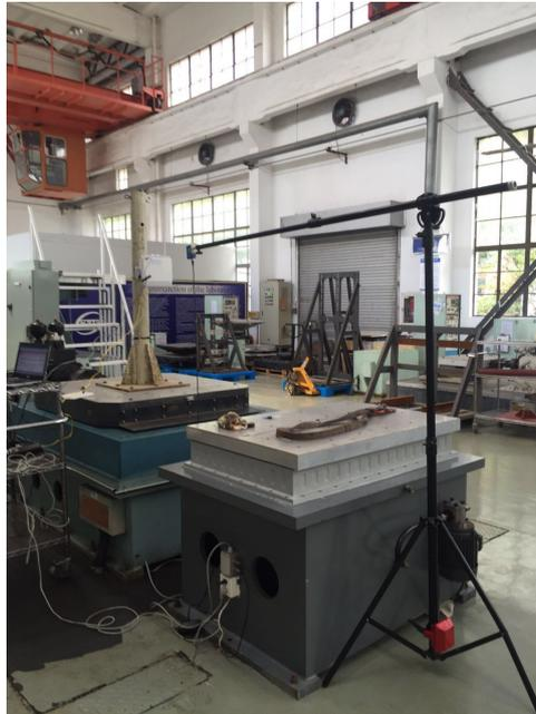
上海天梯检测技术有限公司地震测试是指在特定环境中模拟地震发生的一系列效应，在机械结构上实现水平方向筛动，垂直方向升降和震动功能。以模拟地震横波、纵波、震动效果。地震等级由3-8级可调。液压控制采用闭环伺服控制，可以调节震动平台的震动频率，震幅，和震动波形。动力源采用液压驱动，液压泵站设计功率为5-7.5KW.游戏结束时泵站自动停止工作以节能。震动等级分4个等级，震动强度由弱到强。主控电路采取逻辑联锁设计，可以增强系统运行的地震。第三方地震测试公司，欢迎咨询上海天梯！上海第三方地震测试
